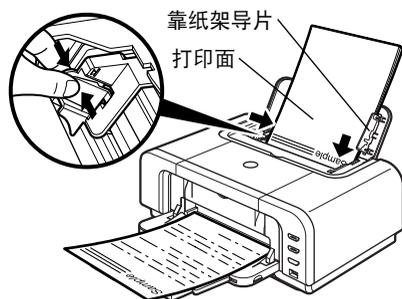
2 装入纸张, 使纸张与靠纸架右边的靠纸架导片对齐。
