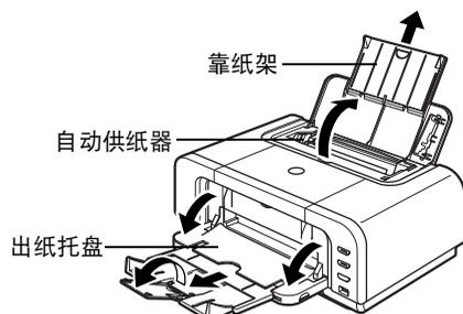
1 如图所示, 完全拉出靠纸架和出纸托盘。
